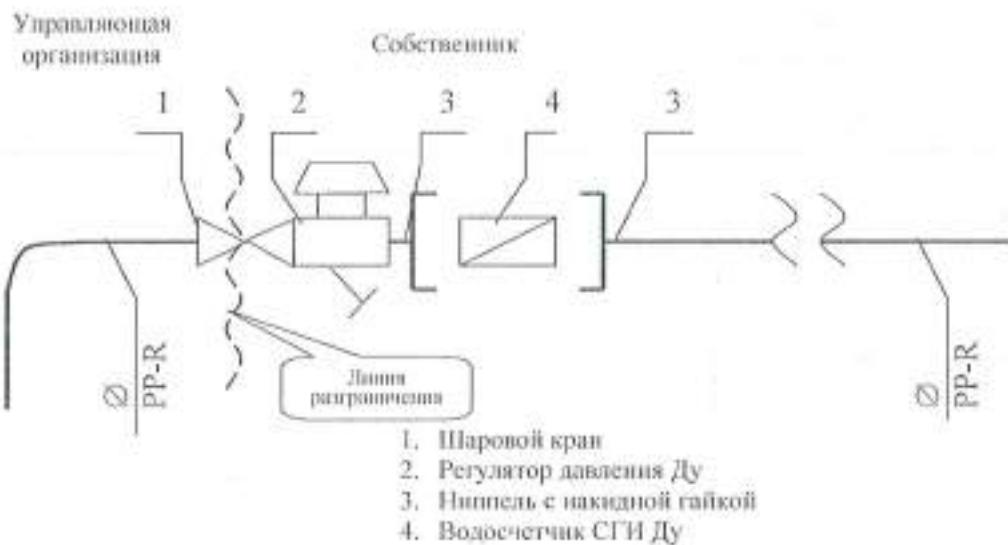
Исполнитель несет ответственность за надлежащее состояние и работоспособность систем горячего и холодного водоснабжения согласно нижес указанной схеме до волнистой линии слева (исключая шаровой кран).
